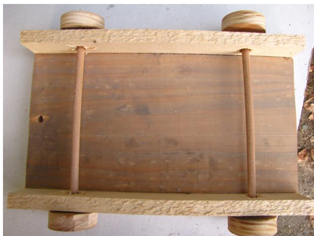
Vissez les deux planches latérales sur la grande planche jusqu'à ce qu'elles soient fermement prises en étau entre celle-ci et la tête de vis. Vue de dessous, passez les tourillons dans les trous et enfoncez les roues à l'aide du marteau. Déposez un peu de colle dans les trous auparavant. Passez la corde, collez 2 endroits de scratch à l'avant, à l'emplacement des pattes avant du lapin. Appliquez l'autre face du scratch sur les pattes avant du lapin.
