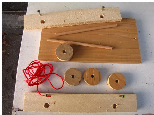
Réalisez les 4 roues à l'aide de la scie cloche dans une planche de 1,5 cm d'épaisseur. En général le foret qui s'utilise avec la scie cloche fait 8 mm, ce qui est le bon diamètre, qui doit être le même que le tourillon. Avec la lime queue de rat, limer le trou des roues. (Si vous n'avez pas ces outils, vous pouvez acheter des roues).
